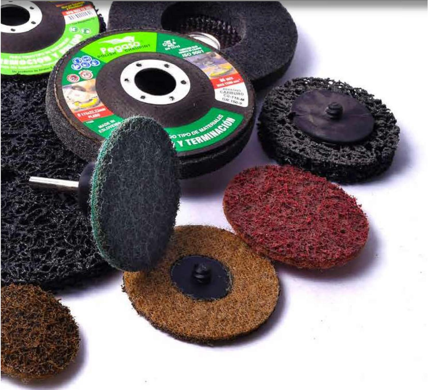
*Está basado en un revolucionario sistema de abrasión constituido por fibras continuas de nylon entrelazadas a las que se les realiza un baño de resina y carburo de silicio. Como resultado de este proceso se obtiene un material de consistencia esponjosa con excelentes propiedades abrasivas.*
